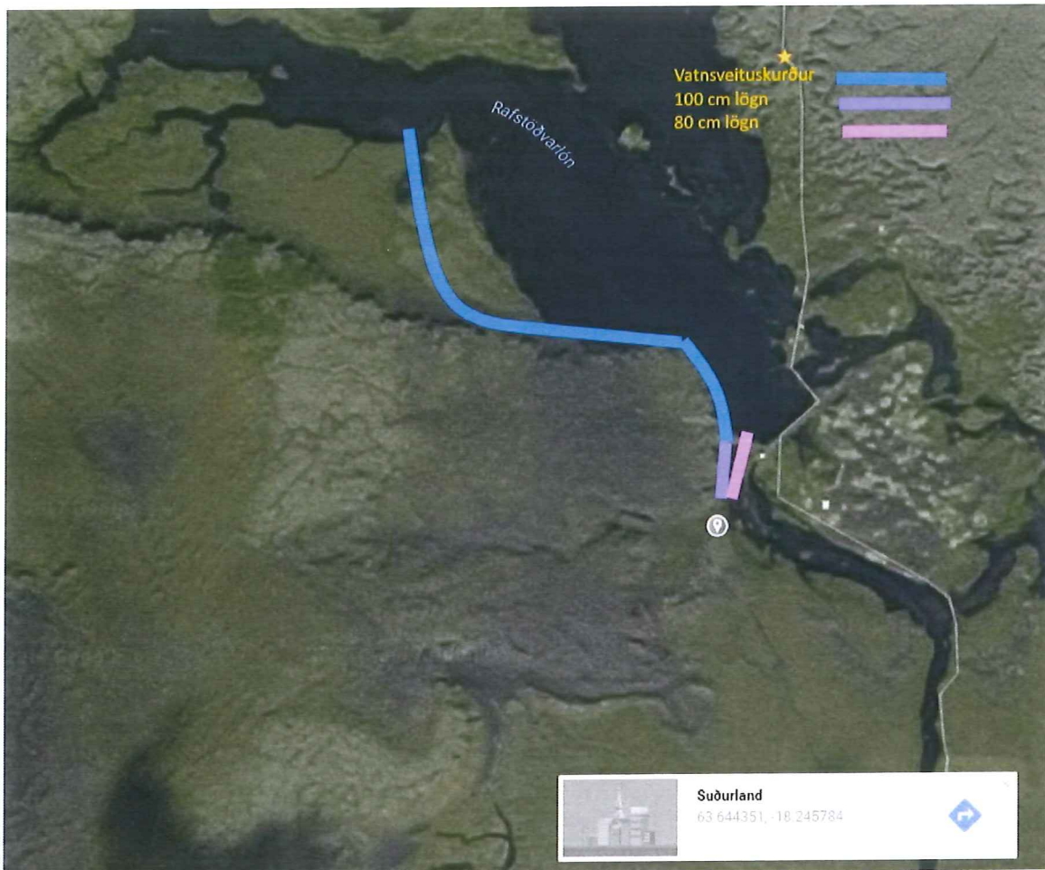
Mynd 3 Veituskurður er blár, 100 cm lögn er bjólublá og 80 cm lögn er bleik
