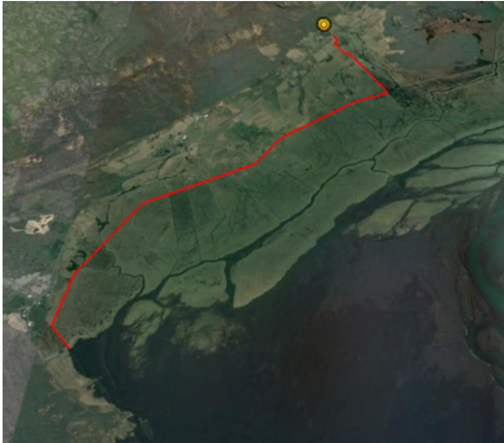
Mynd 4: Eðlilegasta leið frárennslisvatns Fiskalóns um skurðakerfi mýrarinnar. Við ferilinn má sjá minni skurði og viðbúið að hluti frárennslisvatns leiti í þá, en meginstefna vatnsins er meðfram rauðu línunni. Leið rauðu línunnar er 7,3 km.
