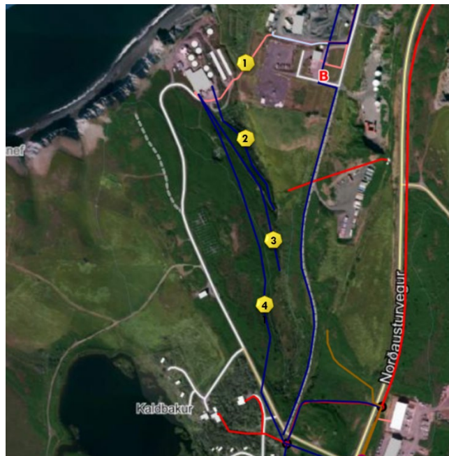
Mynd 3.4. Vatnslagnir hjá Fiskeldinu Haukamýri. Nr. 1 er heitavatnslögn (77-82°C) frá Orkuveitu Húsavíkur. Nr. 2-3 eru kaldavatnslagnir. Nr. 4 eru tvær samliggjandi lagnir ein úr vatnslind ofan við veg og önnur með kælivatni frá Orkuveitu Húsavíkur.
