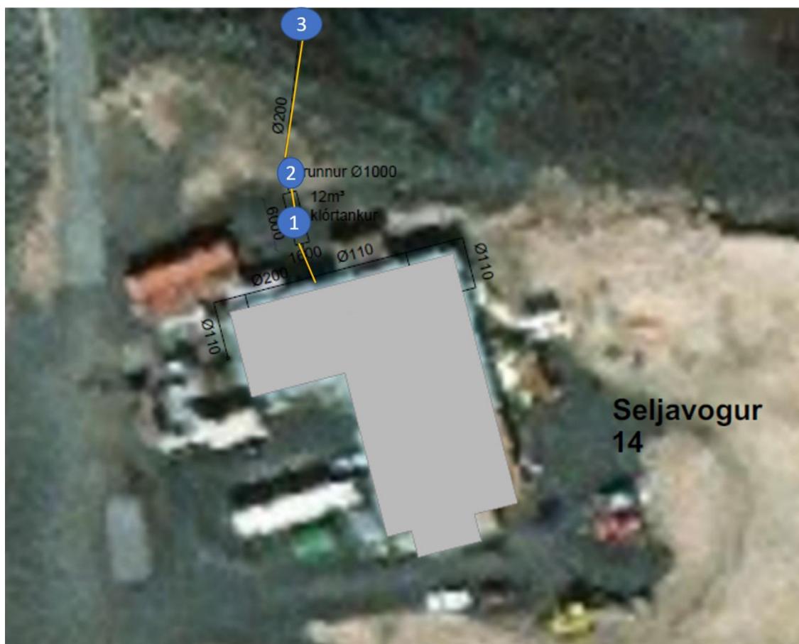
Mynd 11. Hér sést hvar frárennslið kemur út úr eldinu og staðsetning rotþró. 1) 12m 3 klórtankur, 2) fiskigildra, 3) staðsetning frárennslis út í sjó.
