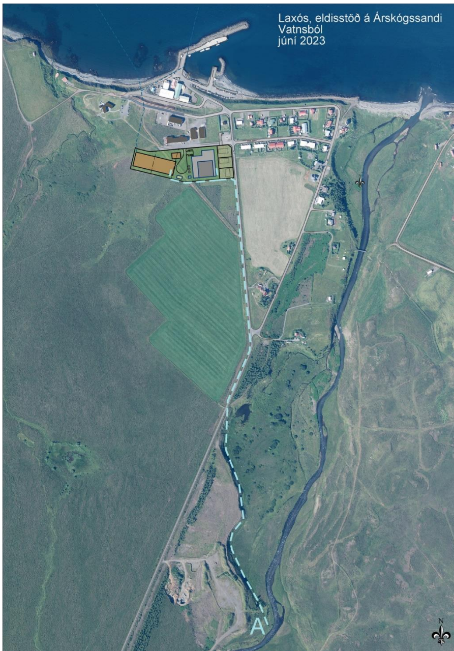
Mynd 7. Á svæði A verður niðurgrafín drenlög í malarjarðveg við árbakkann. Bláa punktalínan tákna niðurgrafna vatnslög (Peh rör u.þ.b. 300 mm) sem munu næra bæði seiða- og sjógönguseiðadeild með fersku vatni.
