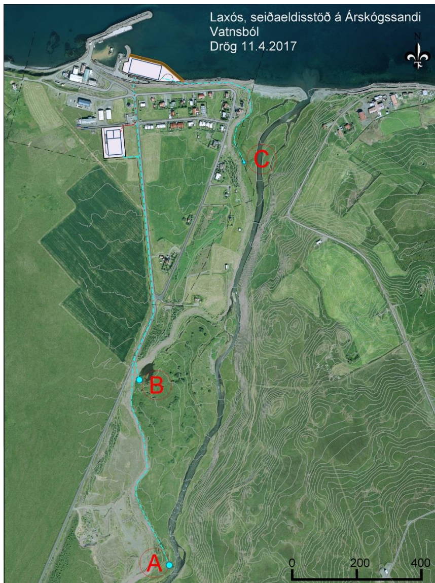
Mynd 5. Á svæði A verður niðurgrafin drenlagn í malarjarðveg við árbakkann. Á svæði B verður borað efir vatni og einnig á svæði C. Bláu punktalínurnar tákna niðurgrafnar vatnslagnir (Peh rör 200 – 300 mm) sem munu næra bæði seiða- og sjógönguseiðadeild með fersku vatni.
